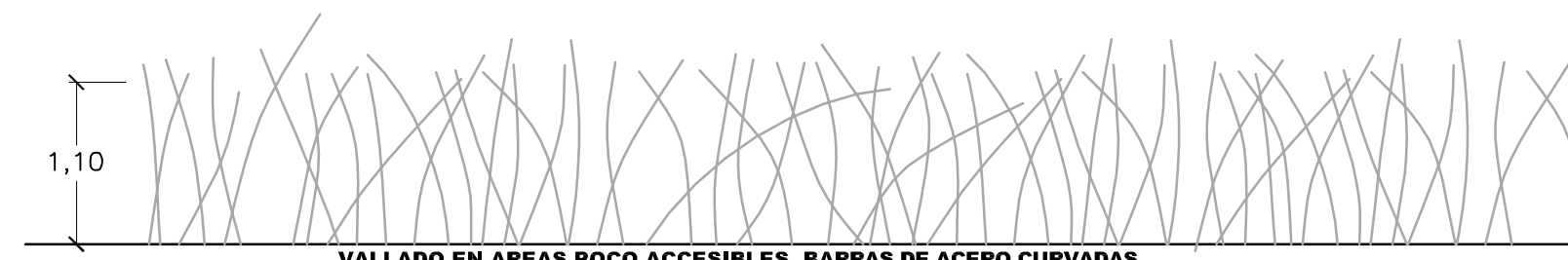
VALLADO EN AREAS POCO ACCESIBLES. BARRAS DE ACERO CURVADAS
