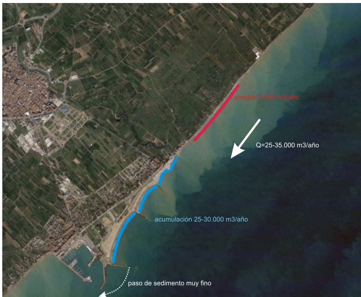
Figura 21. Esquema del transporte litoral en la costa norte de Burriana (Fuente: HIDTMA)
