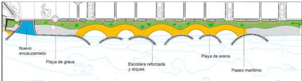
Figura 9. Planta general de las obras de regeneración del frente litoral (Fuente: HIDTMA)
