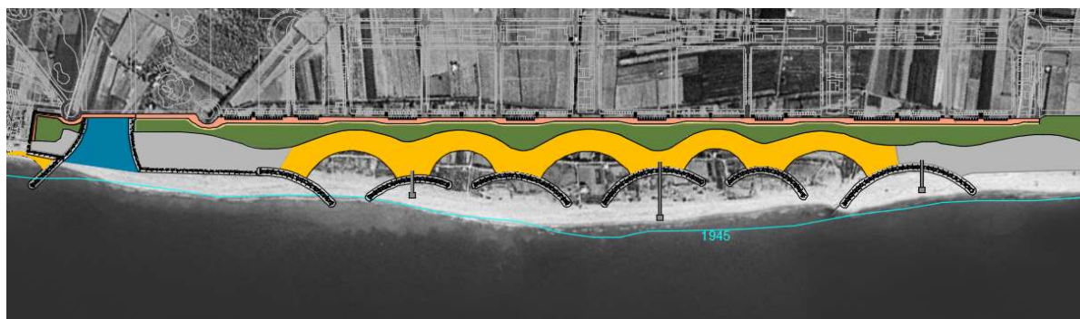
Figura 8. Obras de protección y relación con la línea de costa antigua: fotografía de 1956 y línea de orilla de 1945. (Fuente: HIDTMA)
