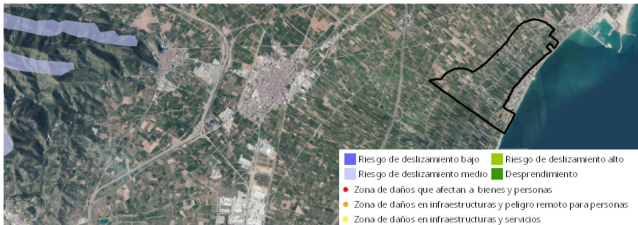
Figura 157. Riesgos de deslizamientos y desprendimientos.
