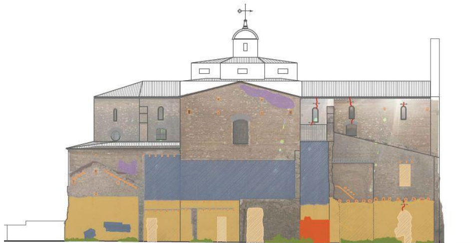
Estudio de las lesiones presentes en el muro oeste de la Iglesia de Sant Blai.
