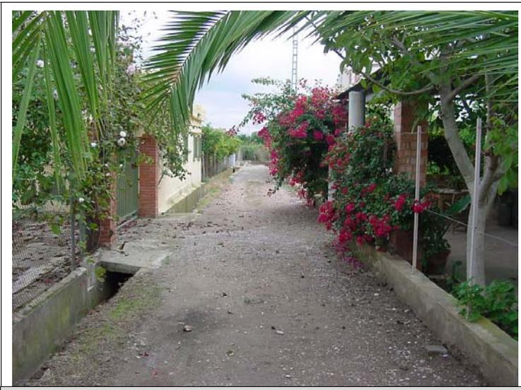
**FOTO N°51:** Acequia de 65x65 cm, camino de 2.5 m de ancho, cerramiento con murete y tela metálica y casas de campo de una altura.
