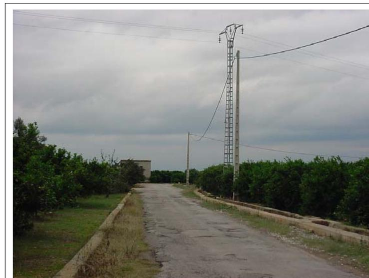
**FOTO N°58: Murete de hormigón de 20x30 cm, camino pavimentado de 4.5 m de ancho y acequia de 55x60 cm.**
