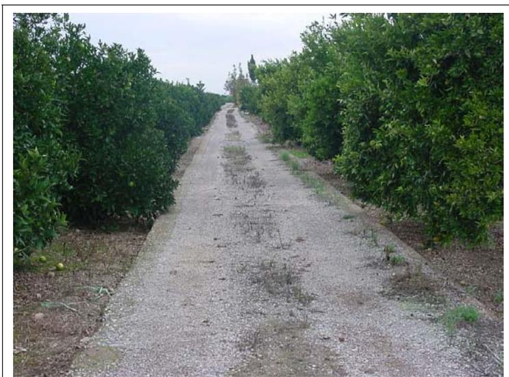
**FOTO N°307: Camino en tierra estabilizado con grava de 2.5m de ancho, entre campos de naranjos y muretes a ambos lados de 25 cm.**
