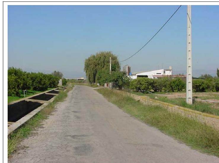
**FOTO N°594:** Carretera de 5 m de ancho, dos acequias de 50x30 y 60x50 cm, línea de baja tensión, edificación de una altura.
