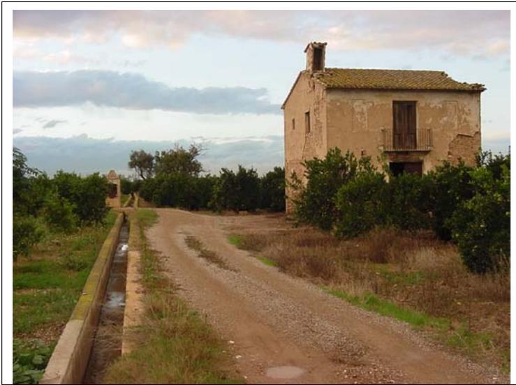
**FOTO N°333:**Camino de tierra de 4 m de ancho con acequia en margen izquierda de 50x50 con muros de 20 y 40 cm de ancho. Edificación de 2 alturas.
