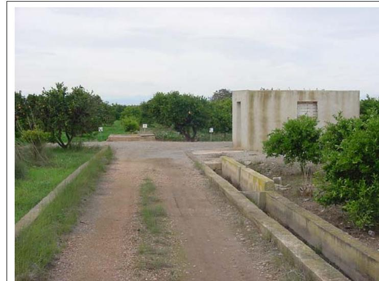
**FOTO N°534: Camino en tierra de 2.5 m de ancho bordeado por murete de 20x30 cm y acequia de 50x50 cm. Edificación de una altura. Alberca de 3x2 m.**
