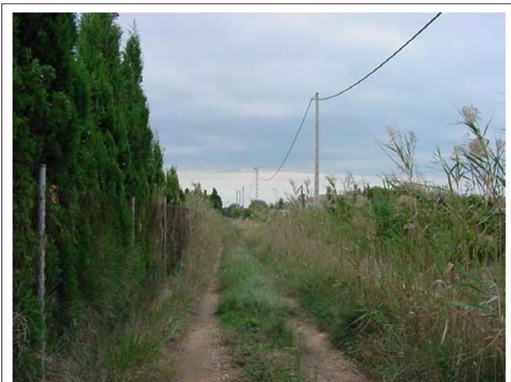
**FOTO N°69:** Valla metálica de 2 m de altura y murete de hormigón de 20x20 cm, camino de 1.60 m de ancho, pantalla de cipreses y poste eléctrico.
