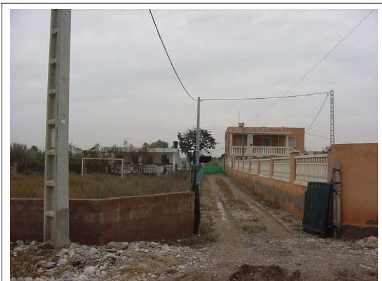
**FOTO N°171: Edificación de una altura. Vivienda de dos alturas con cerramiento de 2 m de altura formado por bloques de hormigón.**
