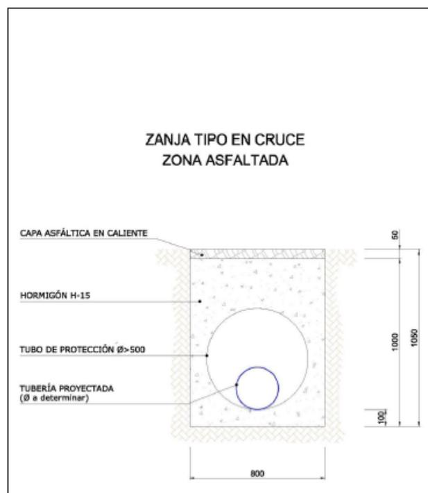
El diámetro interior de la tubería de PVC será de 20 cm mayor al de la tubería proyectada, y en caso de que este valor sea menor de 50 cm, se adoptará un diámetro de 50 cm.
