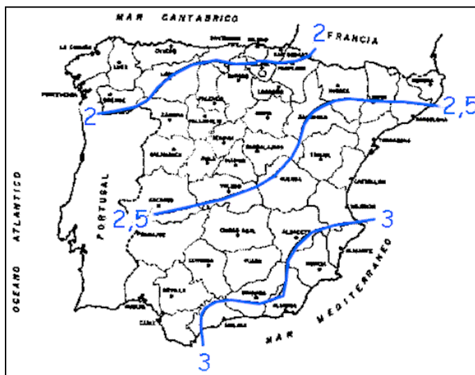
Fig. 10.- Mapa del coeficiente corrector del umbral de escurrimiento según la norma 5.2-IC
