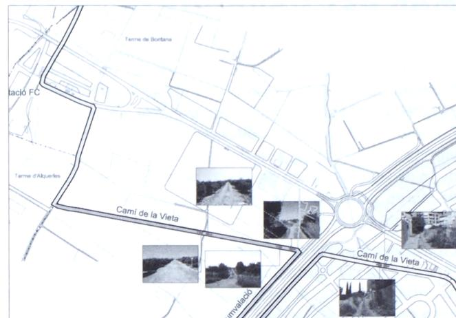
La actuación comprende la limpieza del firme, con la retirada de la maleza y otros elementos, así como la posterior consolidación del mismo mediante materiales acordes con el medio. De esta forma se conseguirá una superficie transitable, segura y perfectamente delimitada. Además, se recuperarán los márgenes y límites de la vía y se dispondrán los elementos constructivos necesarios para asegurar su protección y solidez.
