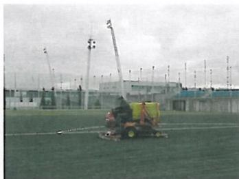
El mantenimiento regular consiste en el cepillado o limpieza de residuos que diariamente puedan acumularse sobre la superficie (papeles, plásticos, pipas, contaminantes atmosféricos), que se van depositando con el paso del tiempo.
